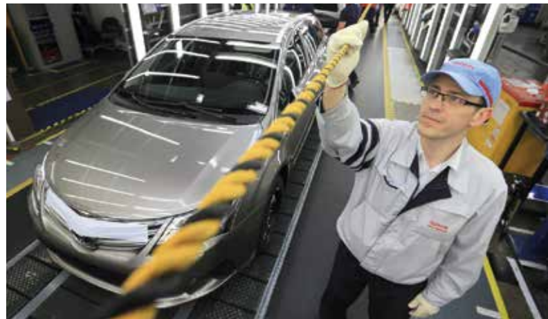
Dank der Kaizen-Philosophie setzt Toyota im Produktionsbereich eine Reißleine ein, mittels derer Fehler sofort behoben werden können.
